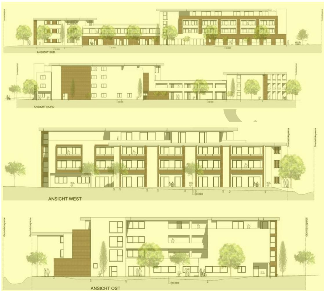
Der gewählte Höhenbezugspunkt entspricht in etwa der geplanten Geländehöhe am Gebäude und orientiert sich an den vorhandenen Anschlusshöhen. Von diesem Punkt wird die Wandhöhe gemessen. Ergänzend zur Wandhöhe wurde eine maximale Firsthöhe festgesetzt. Die festgesetzten Firsthöhen bleiben aufgrund der dadurch bedingt, geringeren Dachneigungen, hinter den Firsthöhen der auf dem Grundstück und in der Umgebung vorhandenen Gebäude zurück.
